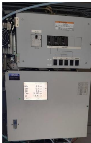
รูปที่ ข.2-1 ระบบตรวจสอบคุณภาพอากาศจากปล่องแบบต่อเนื่อง (CEMS)
